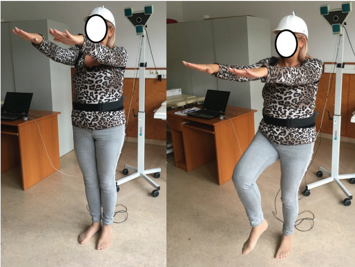
2. ábra. Ultrahang alapú, számítógép vezérlésű, kraniokorpográfiás mérőrendszer (WIN-BALANCE 1.7, ZEBRIS, Medizintechnik GmbH)
